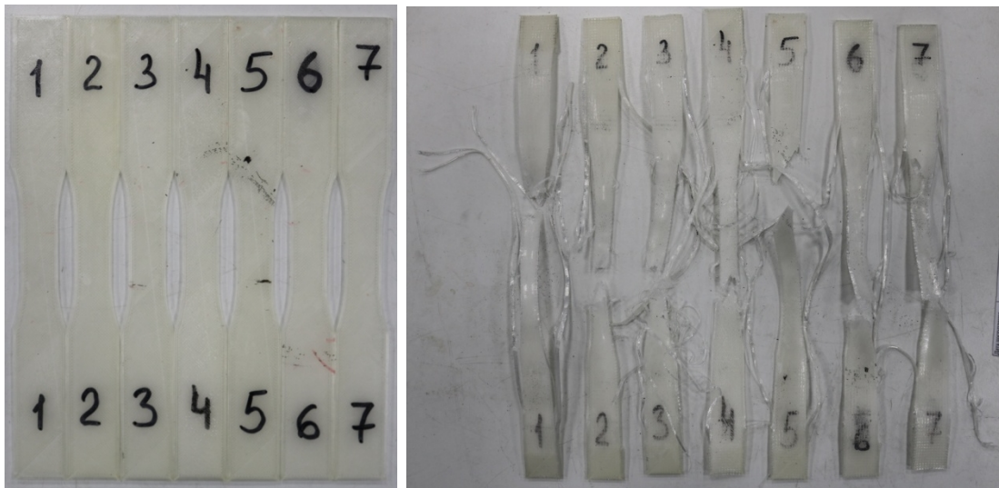
Фотографии элементарных образцов 1÷7 до и после испытаний
