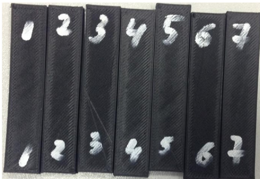
Фотографии элементарных образцов REC RUBBER до испытаний
