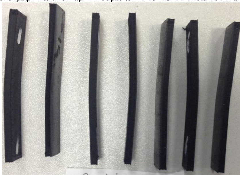
Фотографии элементарных образцов REC RUBBER после испытаний
