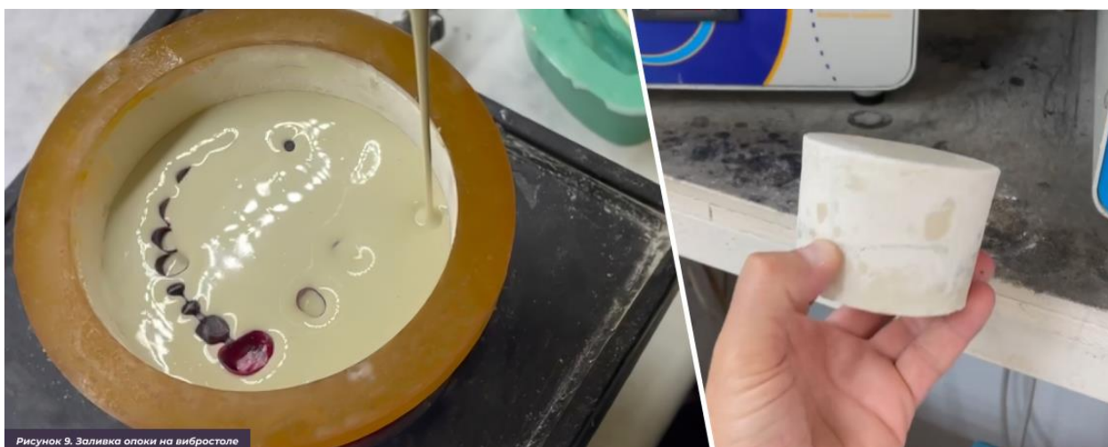
Рисунок 9. Заливка опоки на вибростоле
