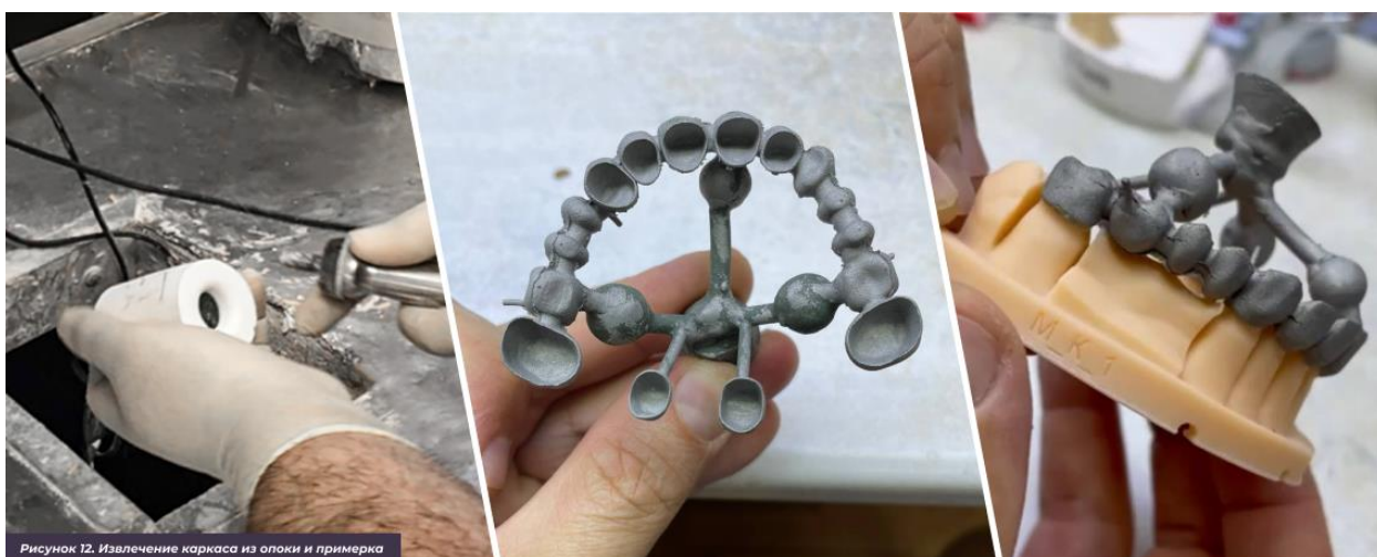
Рисунок 12. Извлечение каркаса из опоки и примерка
